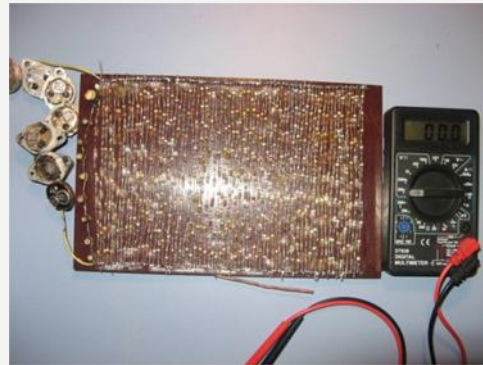
СОЛНЕЧНАЯ БАТАРЕЯ, СОБРАННАЯ ИЗ ДИОДОВ И ТРАНЗИСТОРОВ (УЧАЩИЕСЯ 9 «А» КЛАССА)
